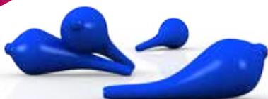
Los canales de fusión se caracterizan por la extrema facilidad en el llenado de la pieza mientras la forma del canal permite un posicionamiento perfecto en el cilindro. Con un cálculo inicial del peso de las boyas y del modelado, se logra compensar las contracciones de la aleación durante el enfriamiento.
