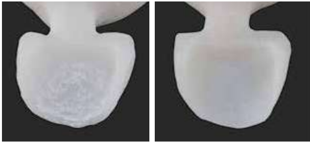
Disilicato de litio Chorroado después del desmuflado Capa de reacción
