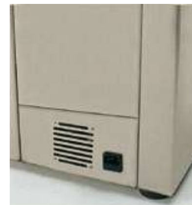
Ventilación forzada de enfriamiento de la cuba, al alcanzar la consigna C1.
