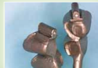
Finalizar el colado para quitar la barra cerámica del agujero, usar una fresa de bola o ácido fluorhídrico.
