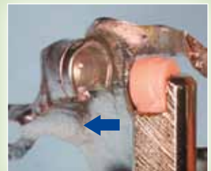
Inserción de la cofia de retención en el contenedor inoxidable en sentido lateral.
