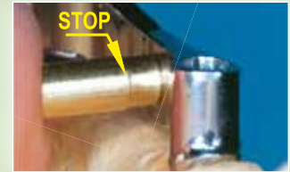
Insertar el conformador del contenedor dentro del orificio y los elementos en su lugar. Asegurarse de no pasar la marca de "stop" cuando se aplica la resina.
