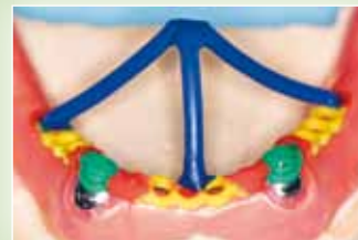
Completar el modelado, colocar los cueles de colado y fundir.
