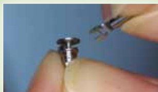
Insertar la llave de ceradura, dentro de la guía de retención y asegurarla con resina.
