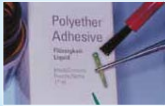
Impregnar el perno con adhesivo
